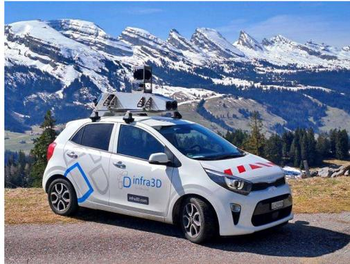
*Mobile Mapping: speziell ausgestattetes Messfahrzeug der iNovitas AG @iNovitas*
